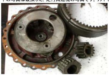
は損傷し、走行不能に陥りました。 原因はキャオイルの劣化による潤滑不良、もしくは オイルシール(ハブシール)からの油洩れによるオイル不足 いずれかが原因です。破損状況が酷い為 潤滑不良かオイル不足かは、断定できませんが 新車時から一度も減速機オイルを交換していない
