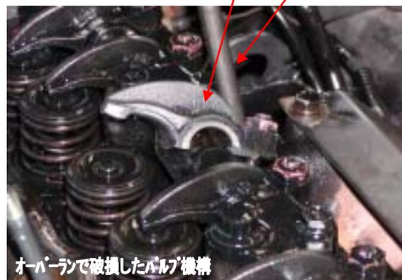
オーバーランで破損したバルブ機構
