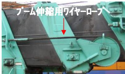
に使用されているワイヤーロープです。ブーム伸縮用ワイヤーロープはメーカー・機種などで異なりますが、**重要定期交換部品**です。点検は緩みや損傷に注意して行ってください。緩みが酷くなるとシーブからワイヤーロープが外れ損傷したり、ブームが急激に縮んだり、思わぬ事故に繋がりますので定期的に点検・調整・交換を行ってください。交換時期に付きましては取扱説明書を参照の上、国際サービスに交換の依頼をしてください。
