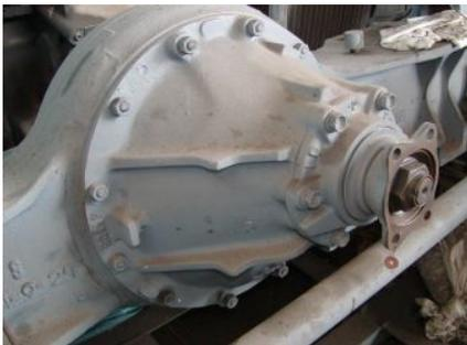
左はラフタークレーンのアクスルに取付てあるデフの写真で、右はアクスルから取外した写真です。デフの構造はドライブピニオンギヤ・リングギヤ2個のデフピニオンギヤ・左右のサイドギヤ・ピニオンシャフト・ケースから構成されており、6個のギヤの組合せで上でご紹介した各作用を行っています。
