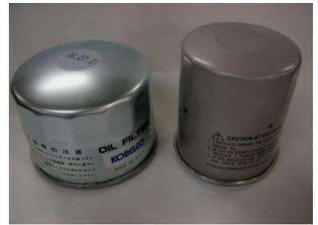
をエンジン本体に送るのに対して、バイパスフィルターはオイルパンからオイルポンプで吸い上げられたエンジンオイルを濾過しオイルパンに戻していることにあります。バイパスタイプのフィルターはフルフロータイプのフィルターより濾材の目が細かくフルフロータイプのフィルターでは除去できなかったカーボン質の汚れや微粒子の除去を行います。
