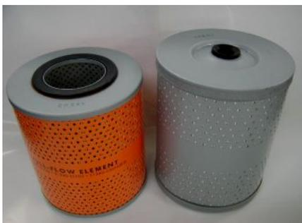
ディーゼルエンジンで多く採用されている濾過方式で、左の写真はセンターホルト式、右の写真はカートリッジ式のフルフロー+バイパス併用タイプのオイルフィルターです。
