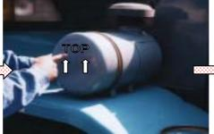
ダストカップを取り付ける前に ダストカップを分解し清掃して 取り付けしてください。 取り付けするとき方向指示マークが 上を向くように取り付けして ください。(マーク付き) クランプは確実に締め付ける。
