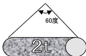
ここで問題です。左の図のように、2tonの荷を吊り角度60度で2本吊りする場合、使用することができる最小径の玉掛用ワイヤーロープ何mmでしょうか？各ロープ径の切断荷重は右の表です。
